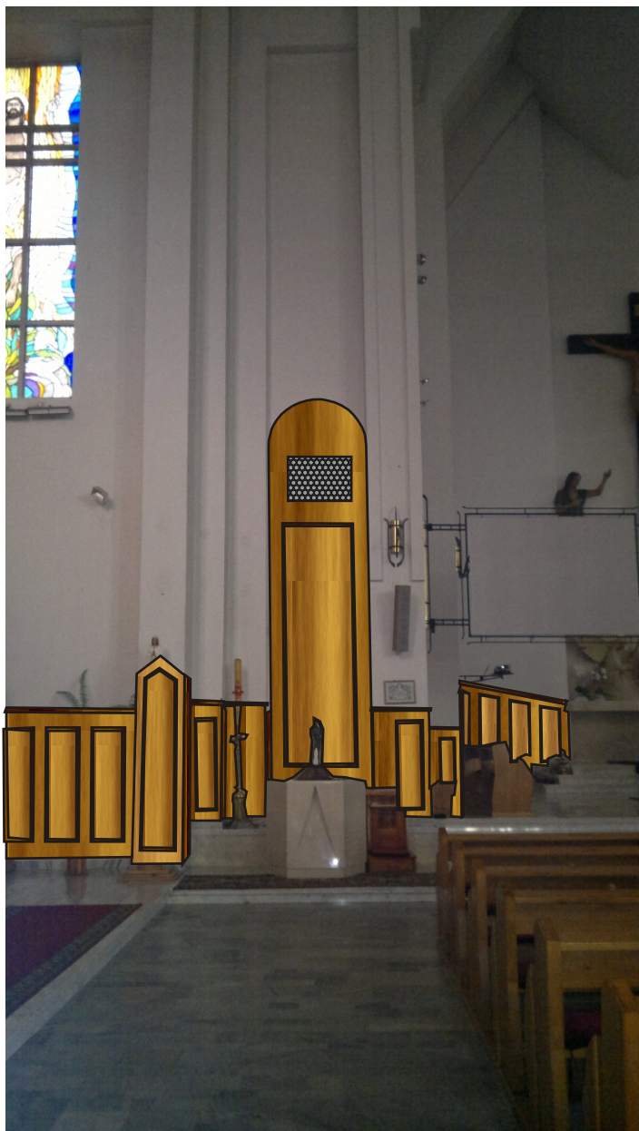
Wizualizacja ściany z chcielnicą ( okładzina drewniana z elementem ekspozycyjnym dla rzeźby lub obrazu ) (zasłonięcie ażurową ozdobną siatką otworu grzejnego ) (wymiary i kształty rozrysowane na ścianie)
